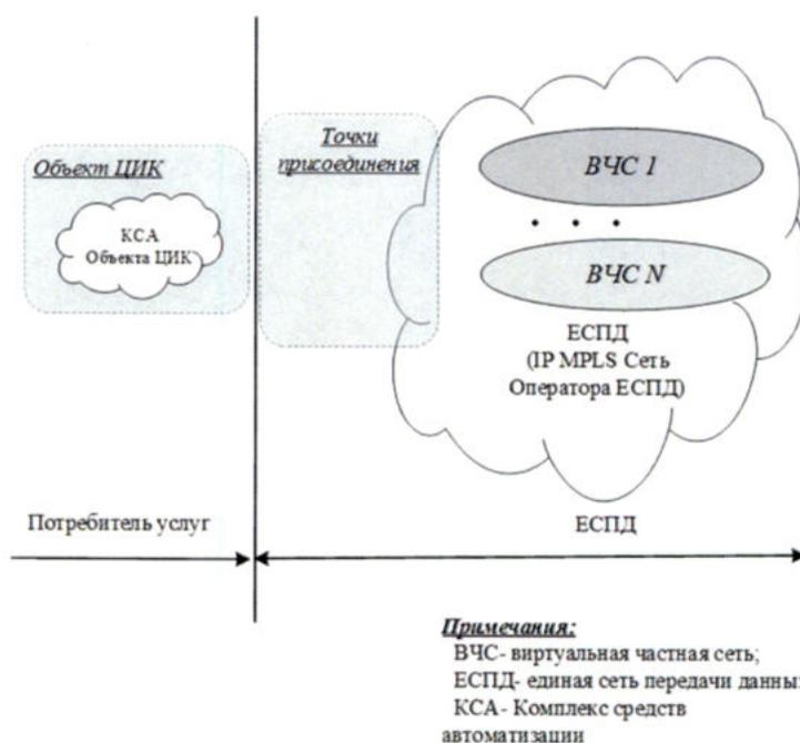
Рис.4.Архитектура Компонента Услуг связи «Передача данных» для Объектов ЦИК.
